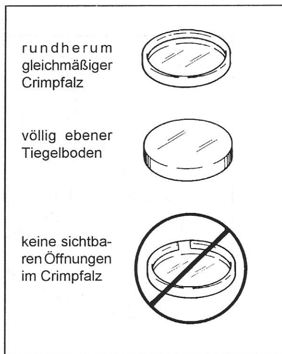
Abbildung 4.5 — Prüfen eines nichthermetischen Tiegels
